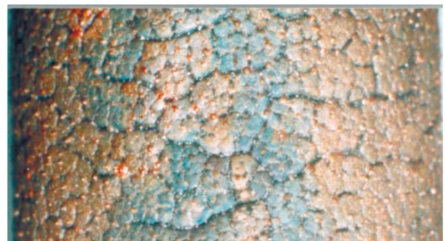
Рис. 7. Поверхность электрода плазмотрона после нескольких часов работы.
